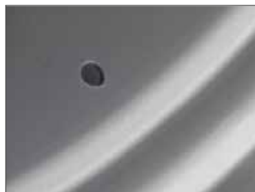
Extra Loch mit Gewinde 3/8" im Felgenring
