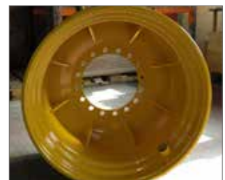
Forstverstärkte Felge mit Spickel
