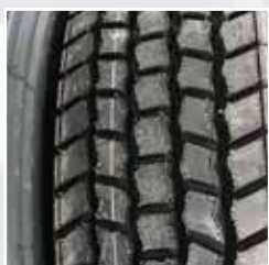
9 R 22.5 WSR 24 Hinterachse (geschnitten)
